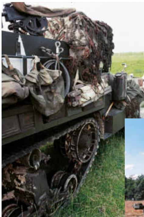
*Les chenilles du half-track sont composées de patins articulés en métal noyés dans du caoutchouc, d'où, un silence de fonctionnement et un confort sans égal.*
